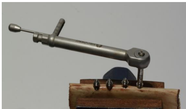
Figura 1. Implantes instalados no bloco ósseo e aplicação de torque no parafuso do componente intermediário com chave de torque manual.
